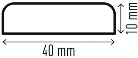
Detailansicht: Maße Flächenschutzprofil S10
