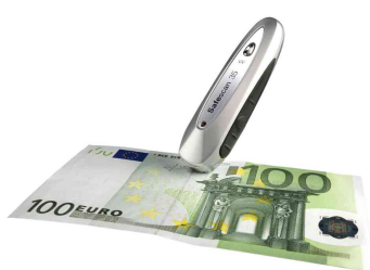
Geldschein-Prüfgerät "Safescan 35", Anwendung Magnetprüfung Euro
