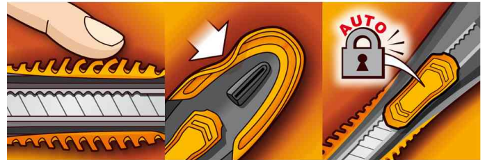
Griffzone aus Softmaterial - selbstblockierender Schieber
